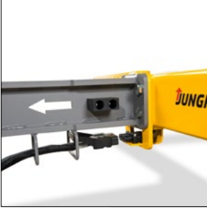
Römorkların elektrik bağlantısı (GTE 312)
